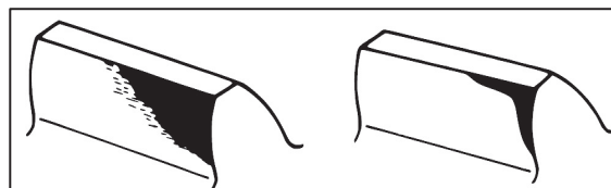
Fig.3.67. Dëmtimi i skajeve të dhëmbëve të dhëmbëzorit
