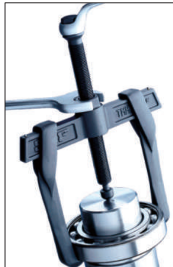
Fig.2.128. Çmontimi i kushinetës duke së përdorur një nxjerrës me boshtin e filetuar
