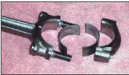
Fig.2.25 Nënshtrësë e dy pjesëshme me dhomë pistoni
